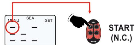
● Exemple: si la photocellule est activée, sur l'écran l'entrée change de normalement fermée à normalement ouverte
